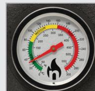
Lecture de la température du four par un thermomètre en °F et en °C
